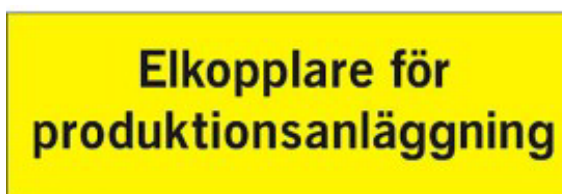
Bild 19. Exempel på skylt som utmärker elkopplare för produktionsanläggning.
